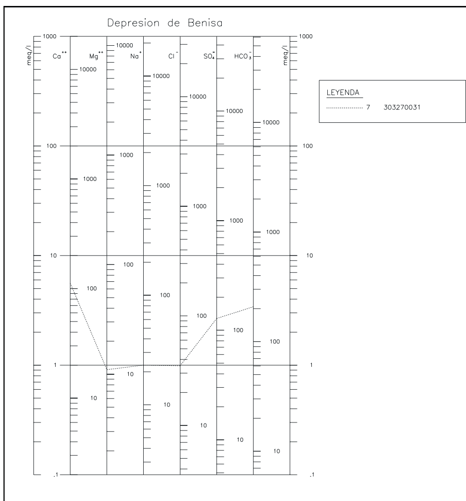
Figura 10.14.13 Diagrama de Schöeller-Berkaloff de la muestra analizada en el acuífero de Benisa
